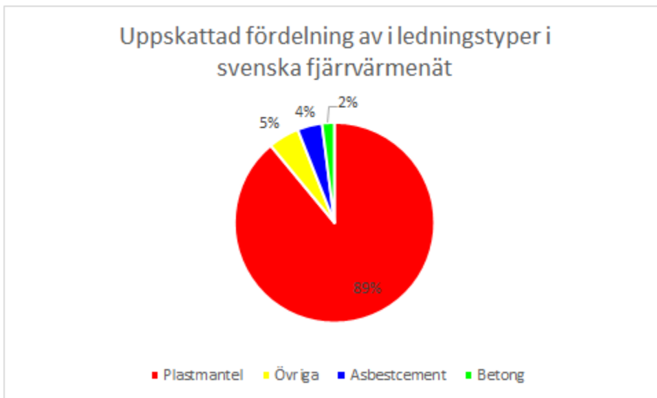
Figur 5 Uppskattad fördelning av ledningstyper i svenska fjärrvärmenät
